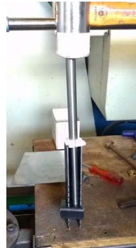
3) Enlever le tube et l'enfoncer sur le pied de fixation à l'aide d'un maillet.
